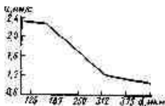
Рис. 11.11. Зависимость линейной скорости горения состава (Mg+NaNO 3 + поливинилхлорид+смола) от размера частиц магния
